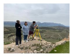
drones y mediciones del mismo con estación GPS y estación total para posteriormente proceder al levantamiento del castillo obteniendo un modelo 3D.
